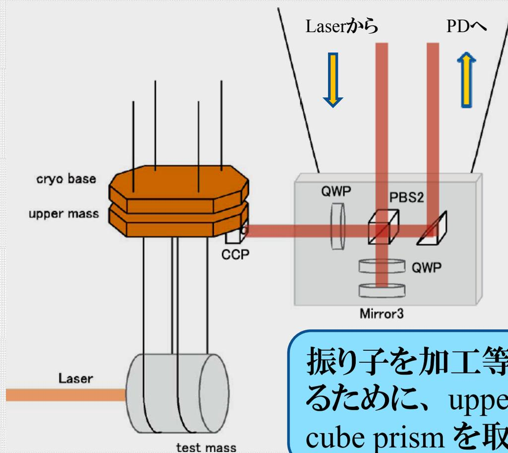
振り子を加工等することなく取り付けるために、upper massの下に corner cube prism を取り付ける予定
