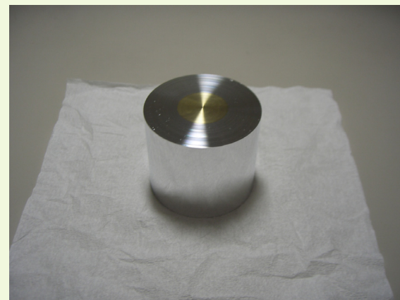
外側のアルミニウム円筒の 内部に真鍮を熱はめしたもの
