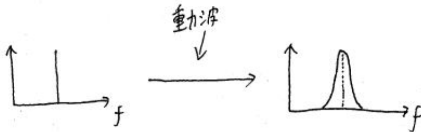
図 5: インジェクション電圧に重力波の信号がのったときの図 (フーリエ空間)
