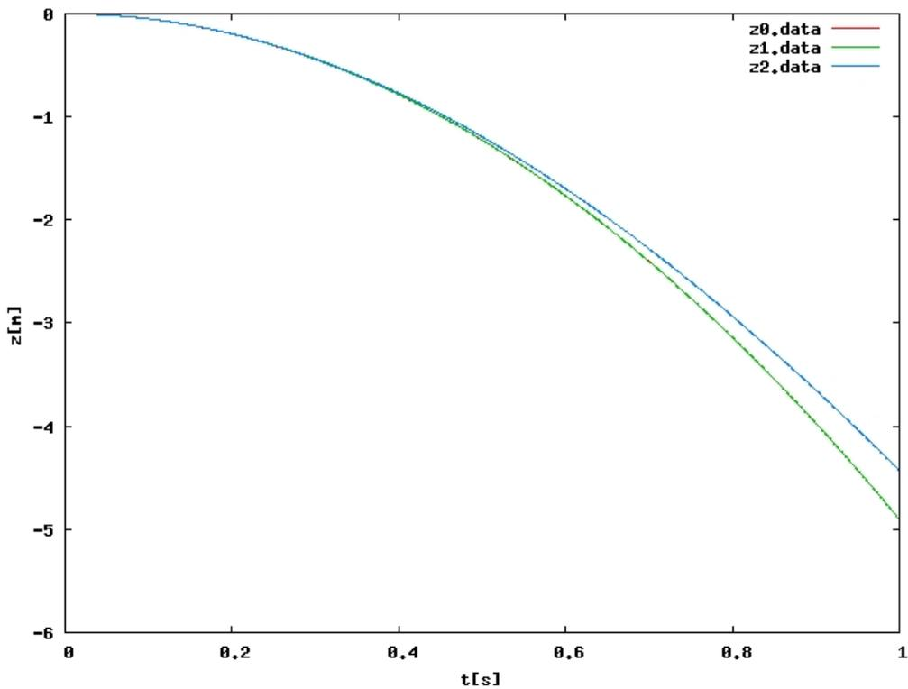
図 2: 落下物体の位置の時間変化。z0 が空気抵抗なし、z1 が速度の一乗に比例する抵抗、z2 が二乗に比例する抵抗。
