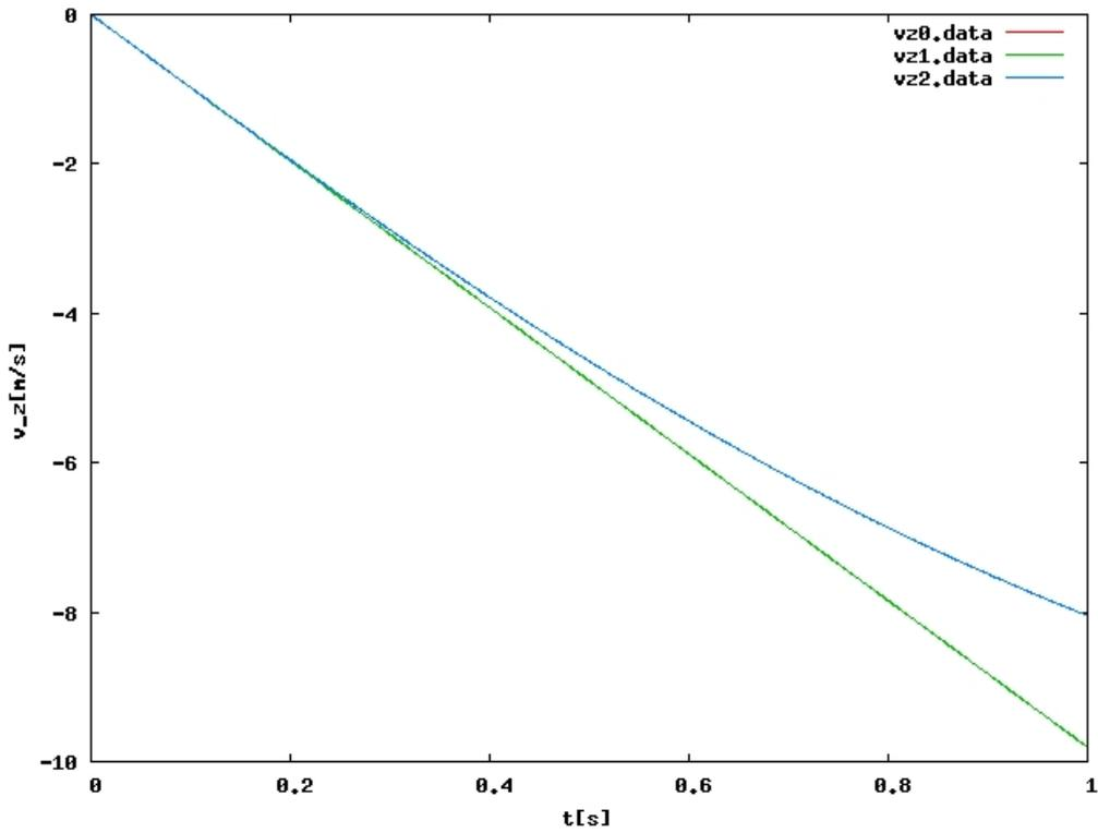
図 1: 速度の時間変化。vz0 が空気抵抗なし、vz1 が速度の一乗に比例する抵抗、vz2 が二乗に比例する抵抗。
