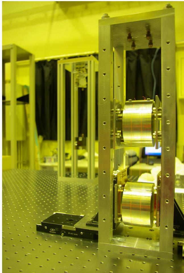
図 1: 実際の 2 重振り子。テストマスは 2 つとも円柱形。1 段目にはマグネットダンピングが施されている。
