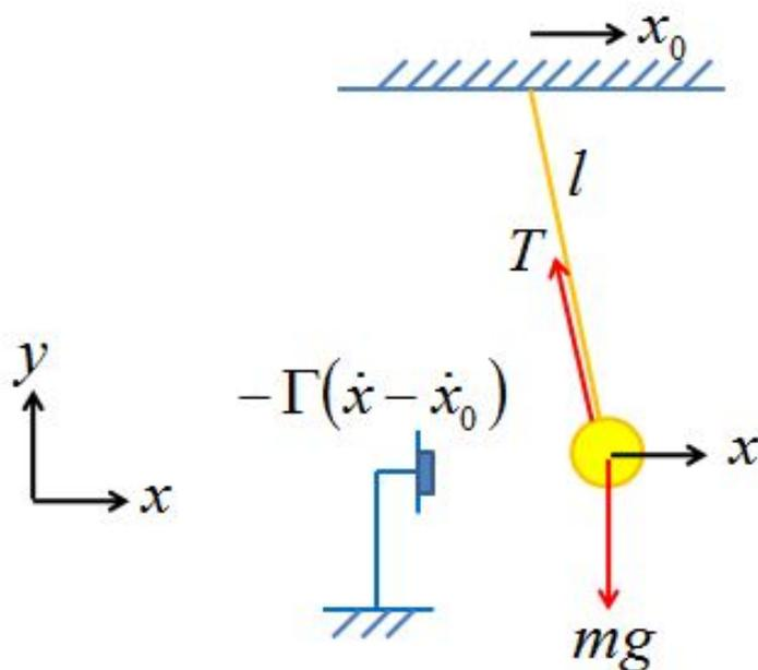
図 2: 1本吊り単振り子。物体は質点として扱う。
