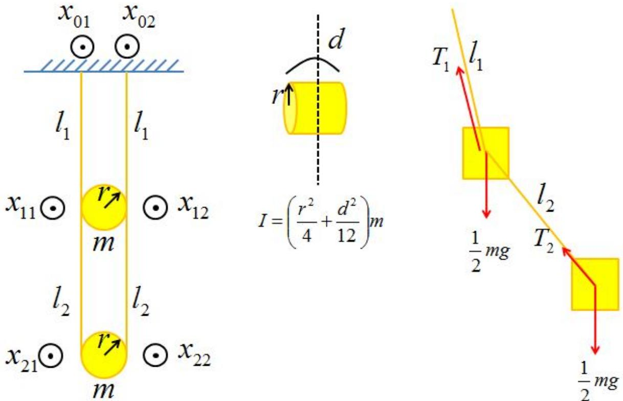
図 8: 2 本吊り 2 重振り子。物体は質点として扱う。
