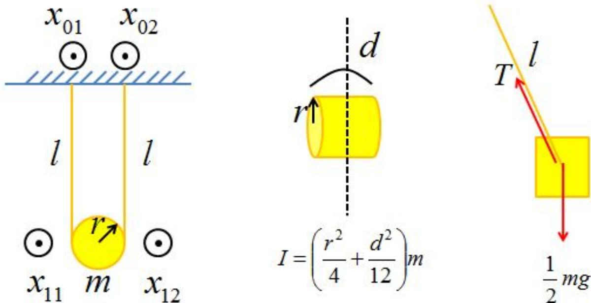
図 6: 2本吊り単振り子。物体は質点として扱う。
