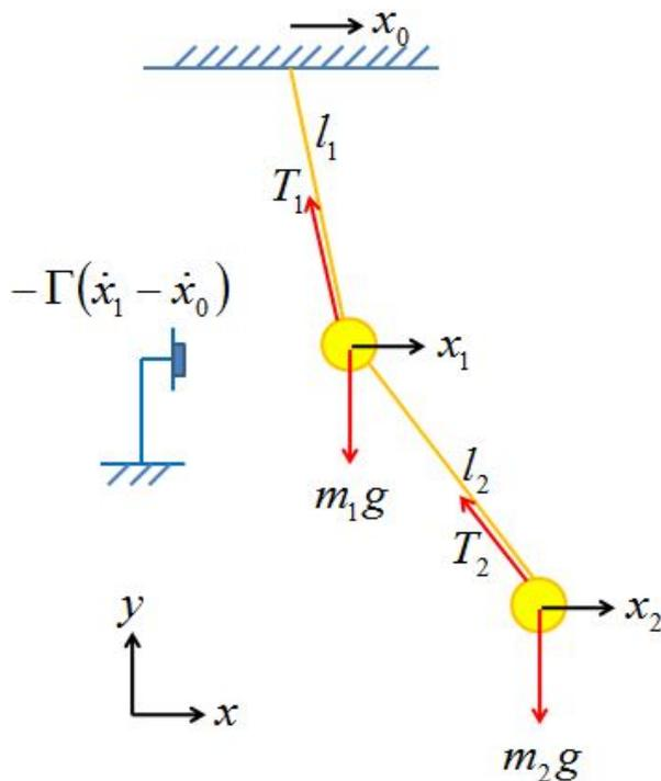
図 4: 1本吊り2重振り子。物体は質点として扱う。
